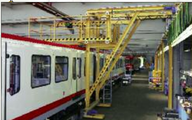
0,6 t Halbportalkran mit Ausschleibe-Brückenträger und ausschiebbarer Arbeitsbühne
