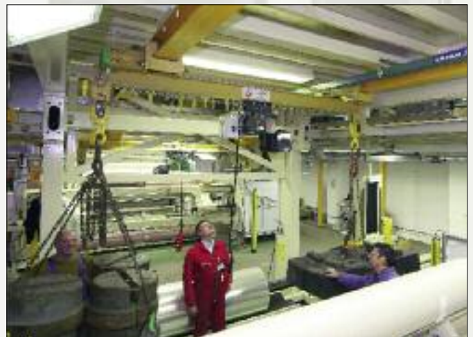
Sonderkran mit 2 x 1,6 t Synchron-Hubwerk
