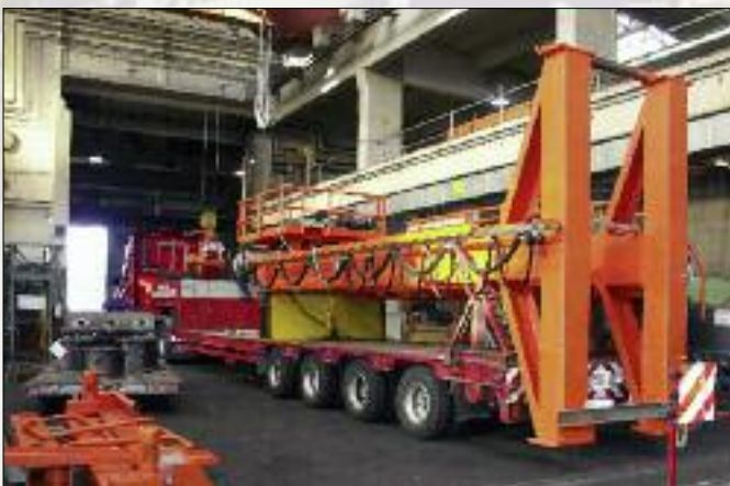
3,2 t Zweiträger-Konsolkran mit 9 m Ausladung
