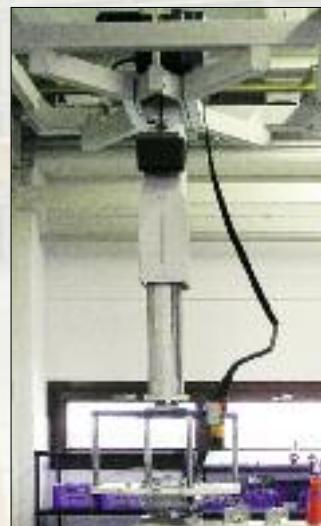
0,25 t Teleskop-Hubgerät für Serien-Montagelinie
