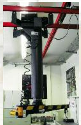
0,25 t Teleskop-Hubgerät für Serien-Montagelinie
