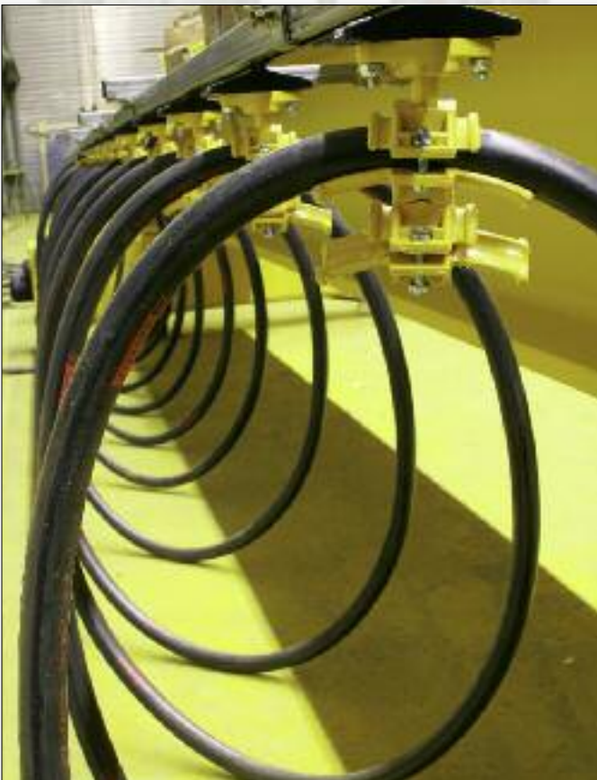
Hauptstromzuführung für Ex-Kran in Sonderausführung
